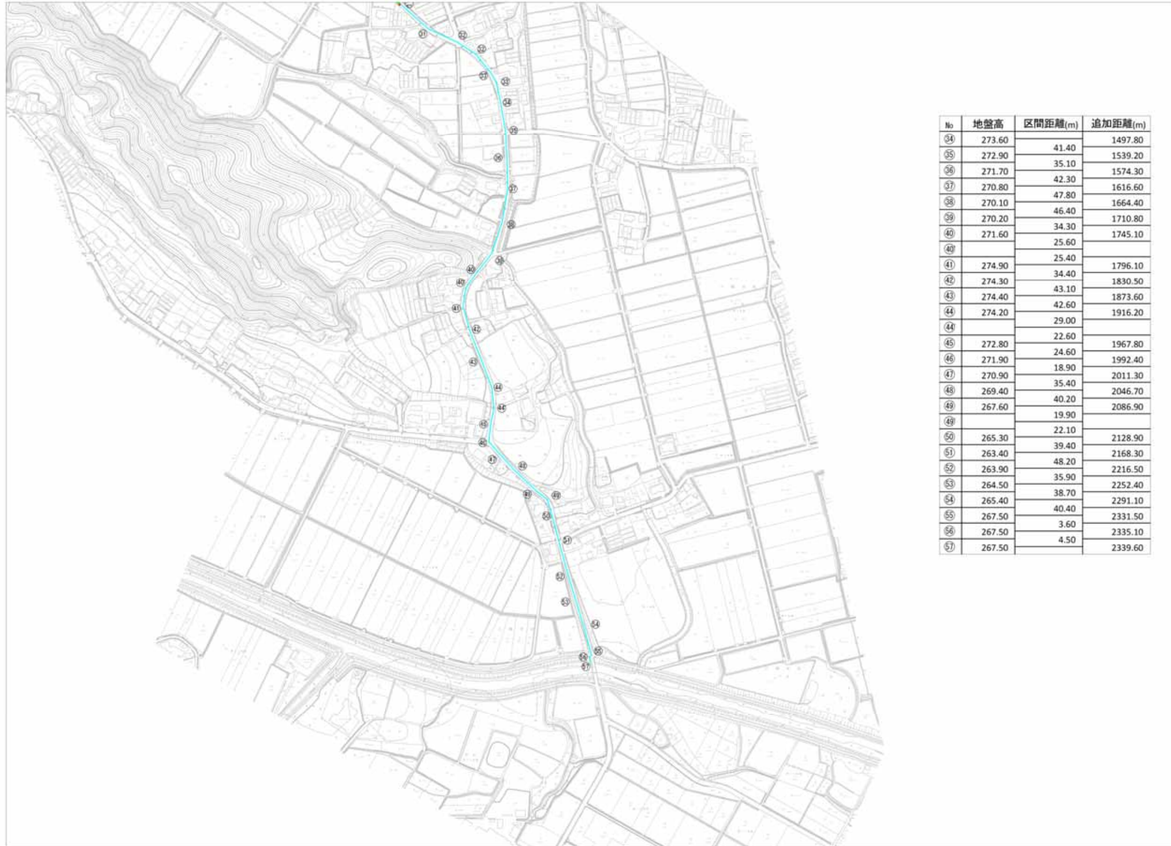
图 5-104 处理水配管平面图（下流側）
