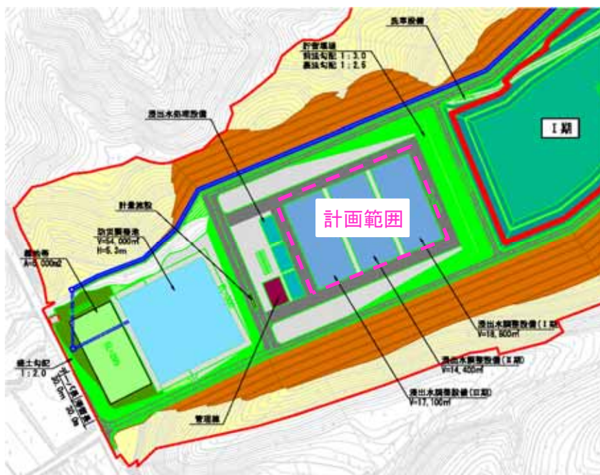
図 5-79 浸出水調整設備の配置計画
