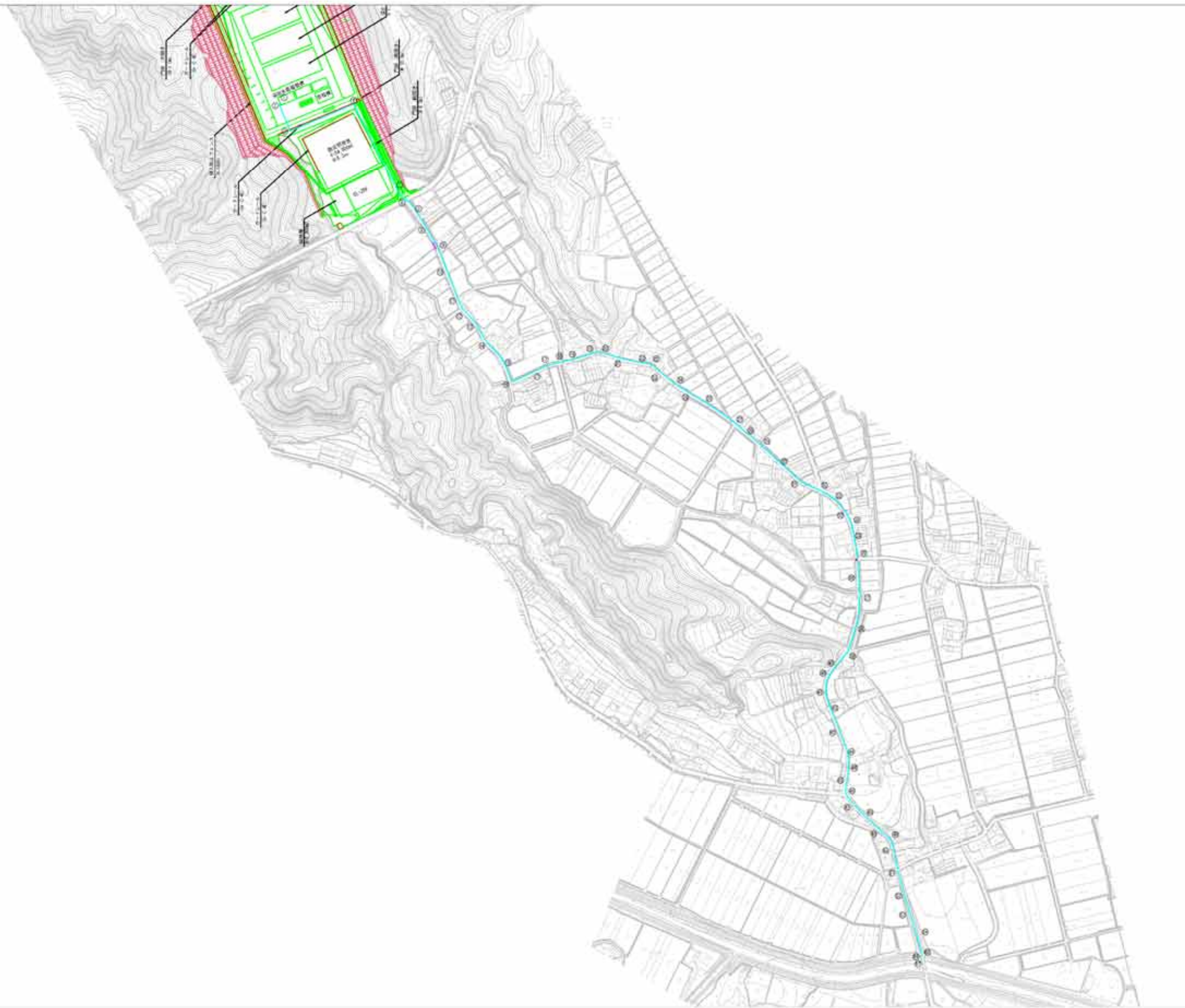
図 5-101 処理水配管平面図（車道ルート案）
