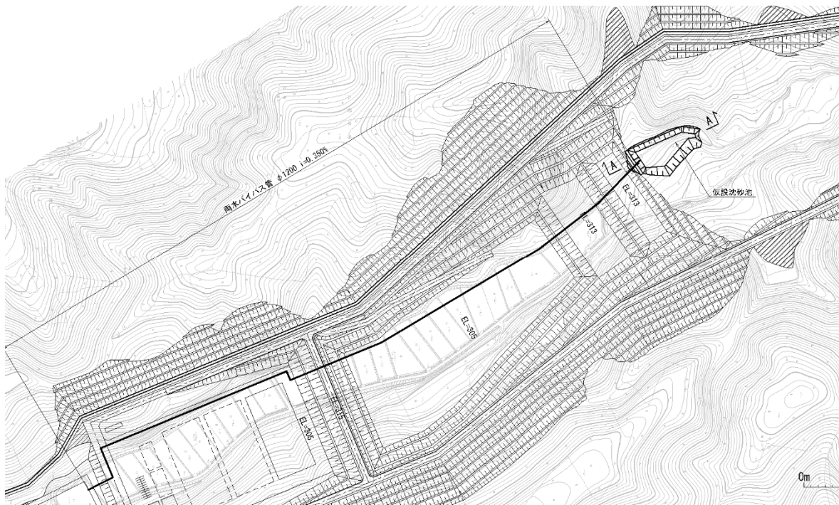
図 8-1 仮設沈砂池（例： 期整備時）
