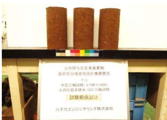
土の圧密非排水(CU)三軸圧縮試験 T-5 試験前供試体
