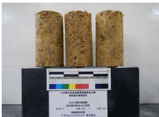
土の非圧密非排水(UU)三軸圧縮試験 B-6T-1 試験前供試体
