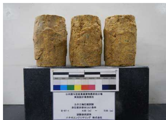
土の非圧密非排水(UU)三軸圧縮試験 B-6T-1 試験後供試体
