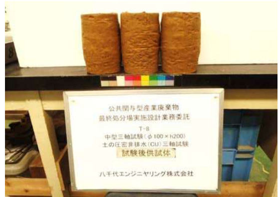
土の圧密非排水(CU)三軸圧縮試験 T-8 試験後供試体
