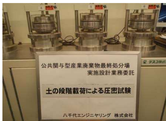
土の段階載荷による圧密試験
