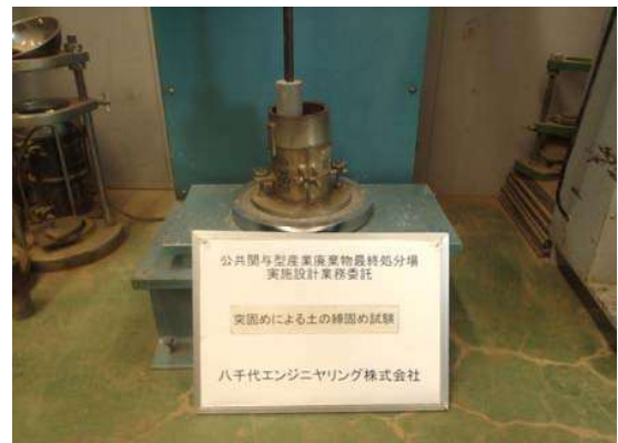
変固めによる土の締固め試験
