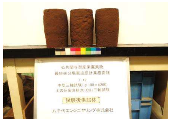
土の圧密非排水(CU)三軸圧縮試験 T-12 試験後供試体
