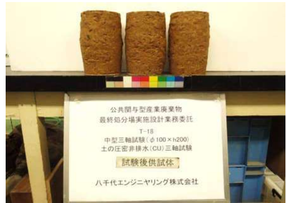
土の圧密非排水(CU)三軸圧縮試験 T-18 試験後供試体
