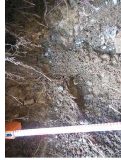
T-13地点 火山麓扇状地堆積物 砂礫主体で細粒分少ない
