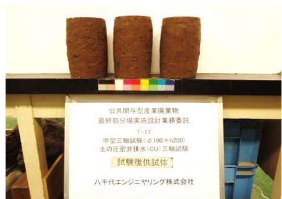
土の圧密非排水(CU)三軸圧縮試験 T-17 試験後供試体
