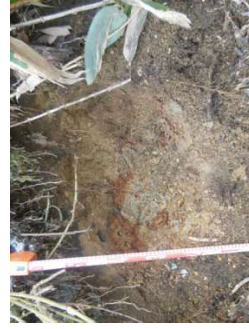
T-15地点 軽石凝灰岩 細粒分多いが、砂分主体
