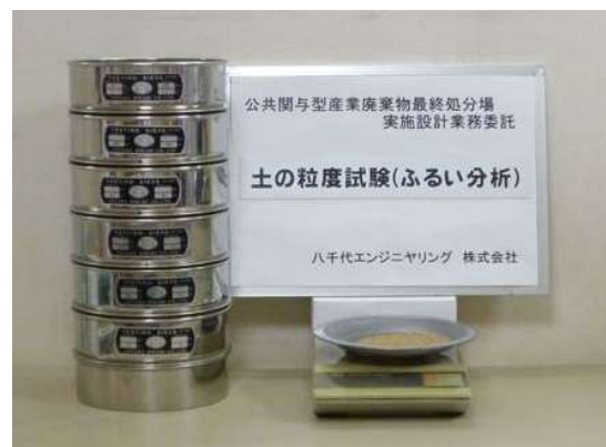
土の粒度試験（フルイ分析：0.5kg以下）
