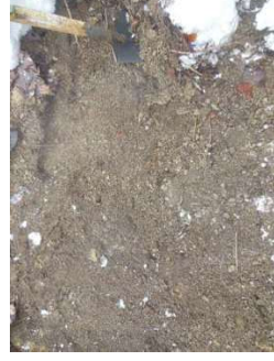
T-16地点 軽石凝灰岩 砂分主体で細粒分少ない
