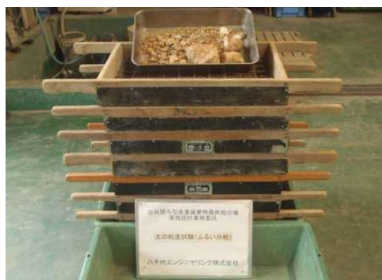
土の粒度試験（フルイ分析：4kg以下）
