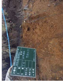
T-5地点 段丘堆積物 粗粒分多く、細粒分少ない
