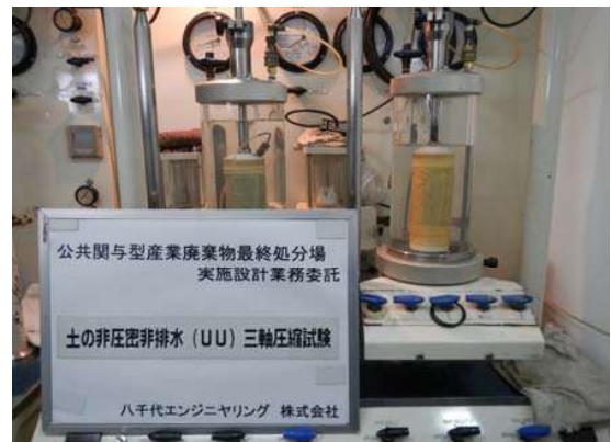
土の非圧密非排水(UU)三軸圧縮試験
