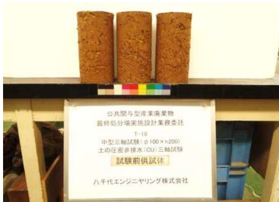
土の圧密非排水(CU)三軸圧縮試験 T-18 試験前供試体
