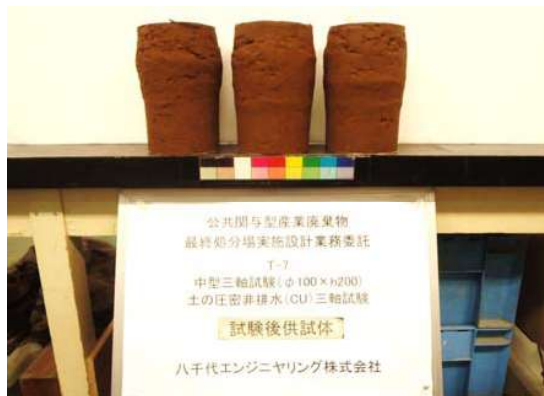
土の圧密非排水(CU)三軸圧縮試験 T-7 試験後供試体
