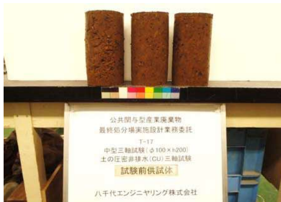
土の圧密非排水(CU)三軸圧縮試験 T-17 試験前供試体
