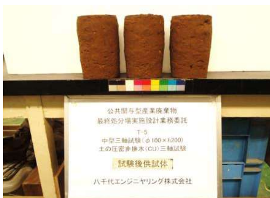
土の圧密非排水(CU)三軸圧縮試験 T-5 試験後供試体
