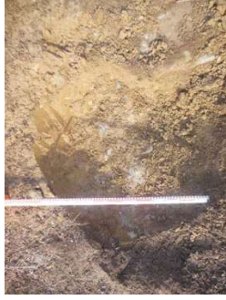
T-9地点 軽石層 細粒分主体で、礫混じり
