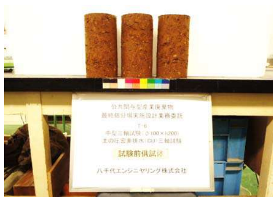
土の圧密非排水(CU)三軸圧縮試験 T-6 試験前供試体
