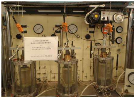
土の圧密非排水(CU)三軸圧縮試験 中型三軸(φ100mm×h200mm)
