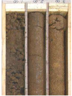
T-8地点 ローム層 細粒分主体で、粗粒分含む 別孔にて試料採取
