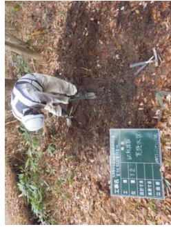
T-2地点 河床堆積物 砂礫主体で、礫が多い
