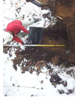
T-17地点 火山礫凝灰岩 強風化により細粒分多い
