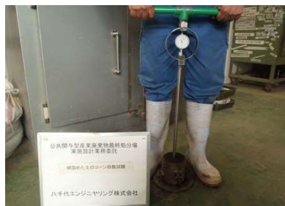
締固めた土のコーン指数試験
