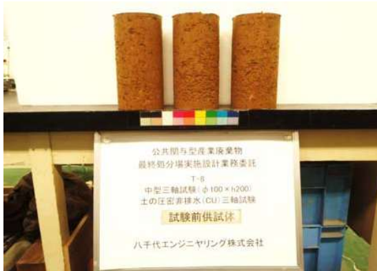
土の圧密非排水(CU)三軸圧縮試験 T-8 試験前供試体
