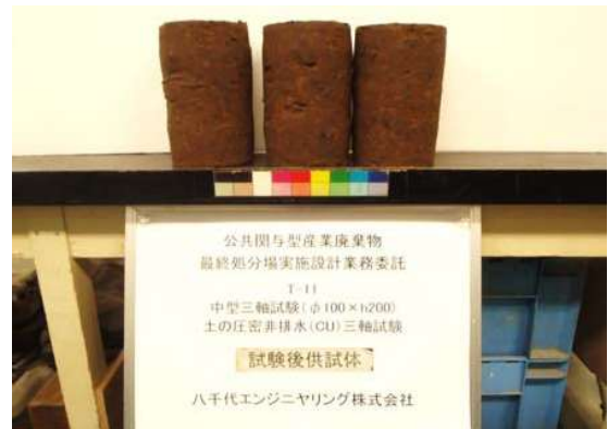
土の圧密非排水(CU)三軸圧縮試験 T-11 試験後供試体
