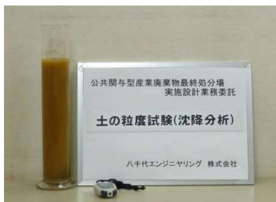
土の粒度試験（沈降分析）
