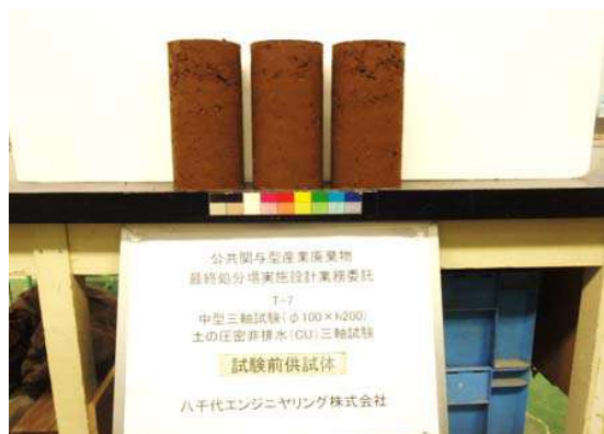
土の圧密非排水(CU)三軸圧縮試験 T-7 試験前供試体
