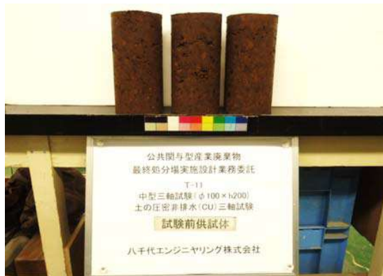
土の圧密非排水(CU)三軸圧縮試験 T-11 試験前供試体
