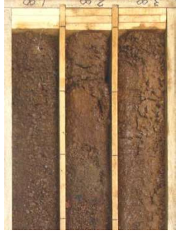
T-7地点 ローム層 細粒分主体 別孔にて試料採取
