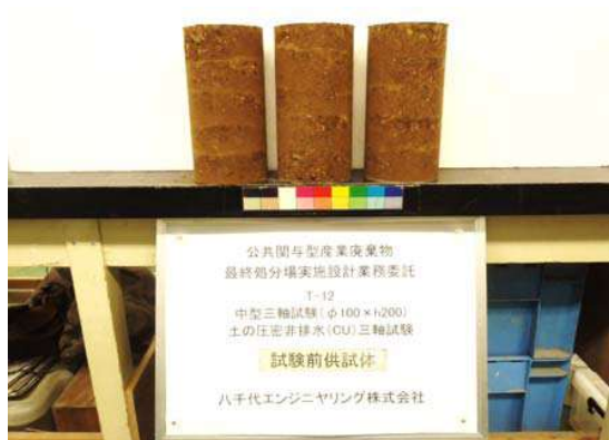
土の圧密非排水(CU)三軸圧縮試験 T-12 試験前供試体
