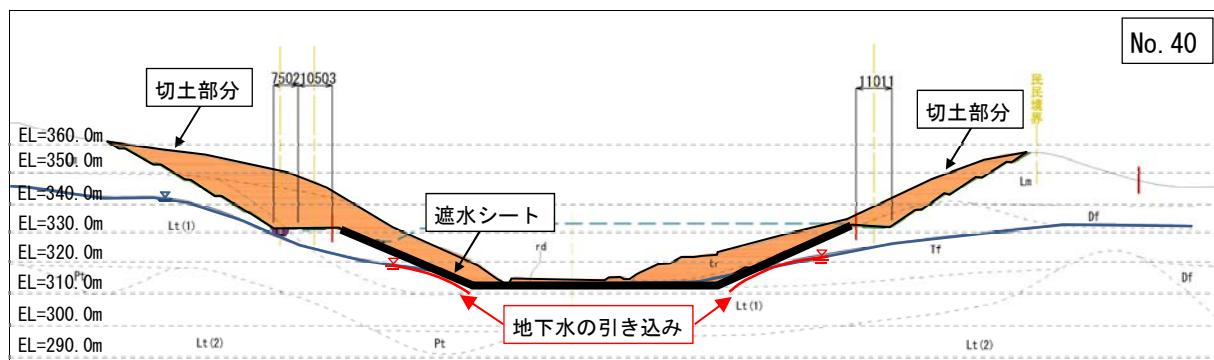
図 6.6-12 断面2：施設の設置と地下水との関係（中流部・I期埋立地）
