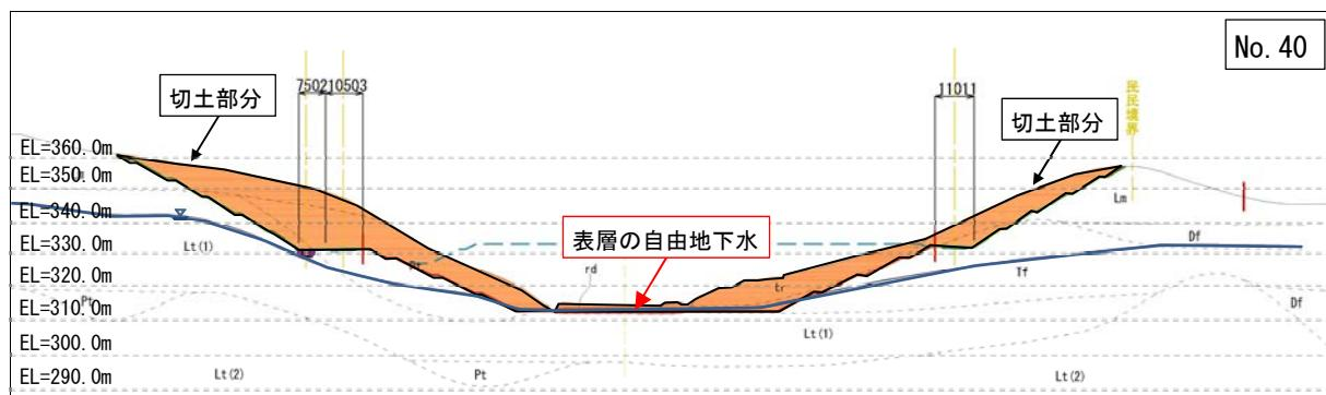
図 6.6-9 断面2：造成に伴う土地改変と地下水との関係（中流部・I期埋立地）
